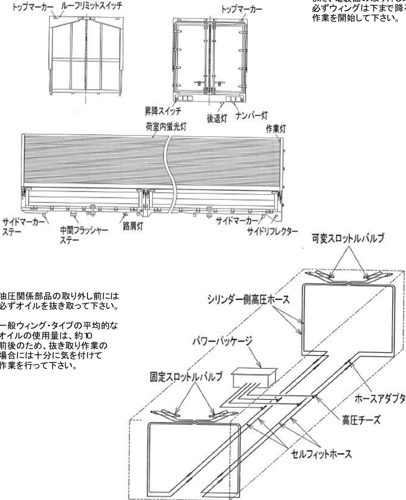
油圧関係部品の取り外し前には必ずオイルを抜き取って下さい。
