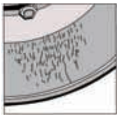
ヒートクラックの発生状況
