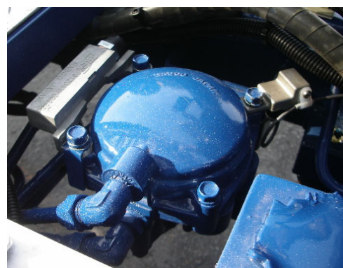
EBS以外のリレーエマージェンシバルブへの「バルブヒーター」取り付け例
