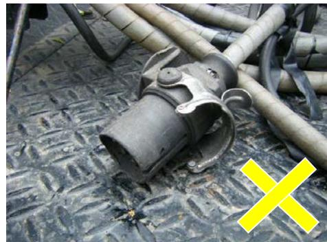
トレーラ切り離し時はABS電源ソケットを、トラクタキャブバックの収納用ソケットへ差し込んで下さい。トラクタプラットホーム上へ放置すると雨水等により端子に錆が発生し、トレーラ接続時に導通不良を起こす原因となります。
